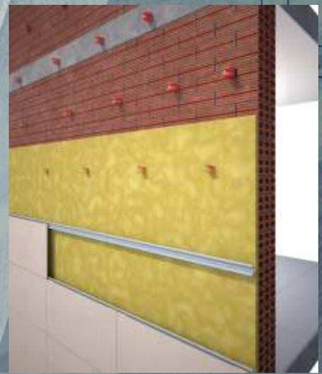
**RETROFIT:** Essa técnica apresenta diversas vantagens: dispensa a remoção do revestimento existente, permite execução rápida e eficiente, trabalha com menor afastamento entre revestimento e parede, além de reduzir custos com a eliminação dos perfis verticais.
