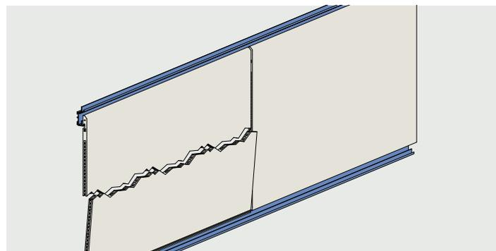
Não requer tela de reforço; em caso de quebra, a parte superior permanece suspensa enquanto a parte inferior fica apoiada sem queda.
